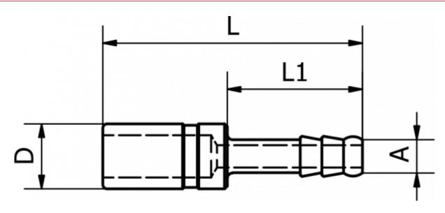
A (mm) = Ø9 D (mm) = 12 L (mm) = 48 L1 (mm) = 25
